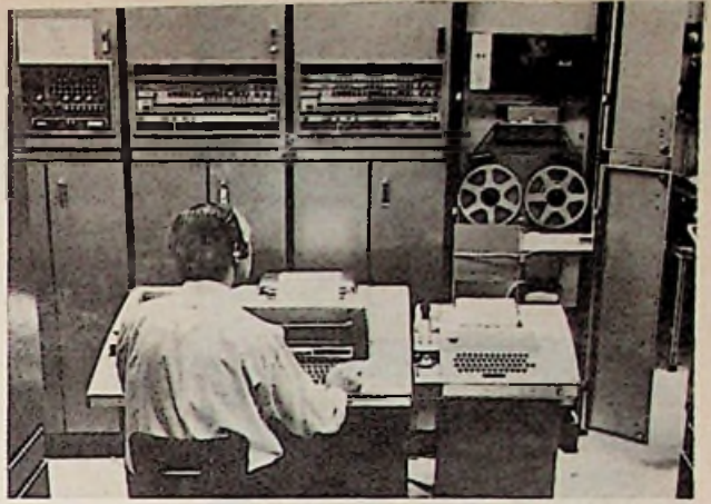
Afb. 1 Man-machine communicatie. Via de teleprinter kunnen de ITT 1600 processoren worden geïnstrueerd of benodigde gegevens worden opgevraagd.
