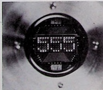
Afb. 2: Voorbeeld van een cijferindicator in gloei-meandertechniek, elke lichtpunt bestaat uit twee loodrechte deeltjes.
