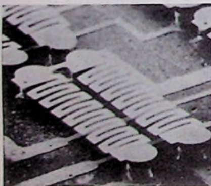
Afb. 1: Lichtpunt voor een laagspanningsindicator, opgebouwd uit een dubbele meandergloeidraad
